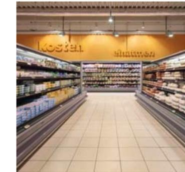
Vertikale Flächen ziehen schon aus der Ferne die Blicke auf sich. Dementsprechend sollte sich auch die Beleuchtung absetzen – in der Regel durch die homogene Flutung der Wandfläche und die akzentuierte Beleuchtung einzelner Objekte.
