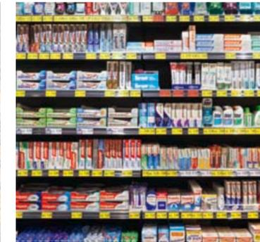
Regale sind die wichtigsten Warenträger. Das Licht sollte hier vertikal ausgerichtet und gleichmäßig über die komplette Regalhöhe verteilt werden. Der Boden bleibt idealerweise unbeleuchtet.
